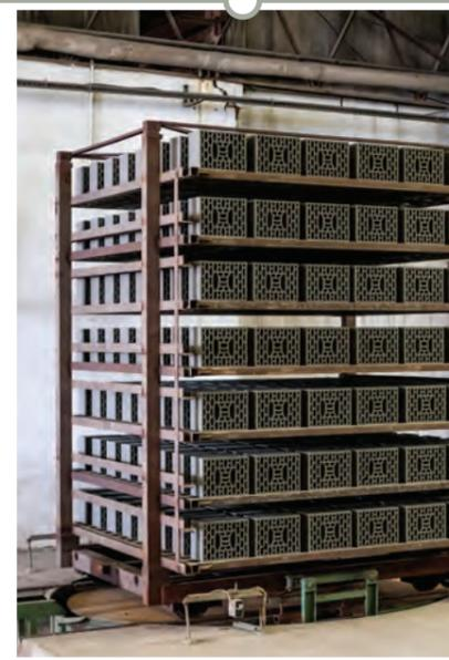
È una operazione che avviene in essiccatoi, alimentati con aria calda di recupero dal forno di cottura eventualmente integrata con aria prodotta da una sorgente di calore.
