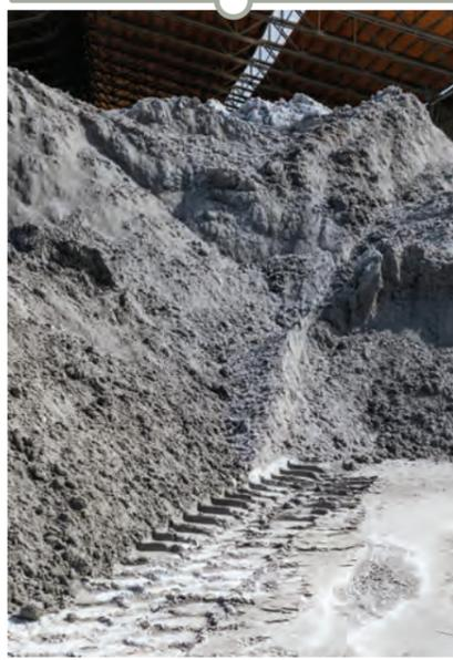
L'argilla viene prelevata dagli scavi e/o dalle cave; questo sedimento viene poi accumulato sotto un capannone pronto per essere posto a lavorazione.
